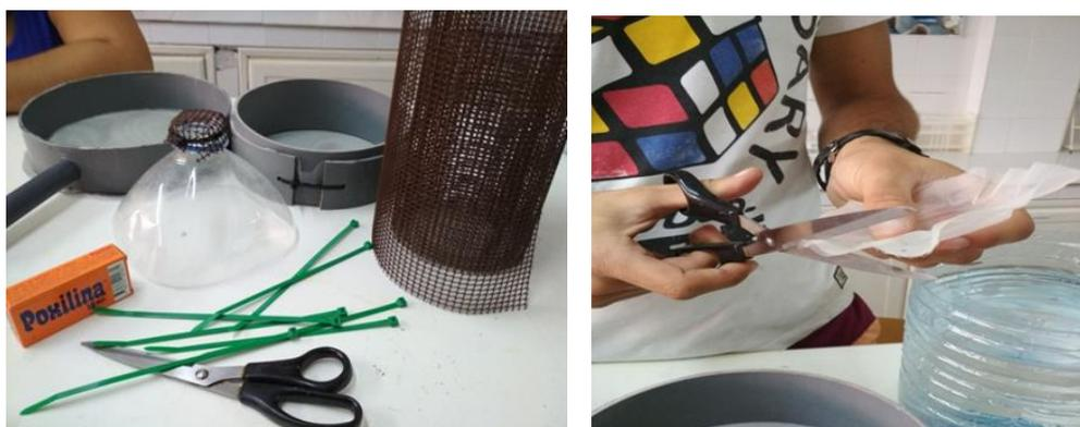
Figura 6.- Fabricación de tamices para retener macro, micro y nanoplásticos.
